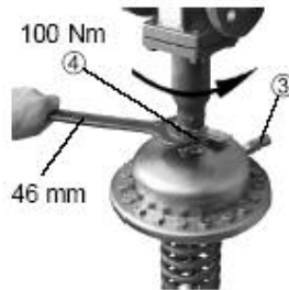
Рис. 6. Монтаж регулирующего блока. (Взято из VI.CA.I1.5U)
